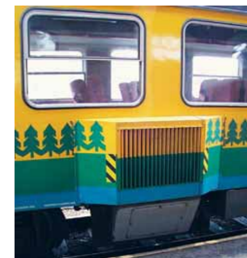
Bild 76. Låda på utsidan av motorvagn hos Värmlandstrafik, ett "snösäkert luftintag". Skyltar på vagnens ändar varnade för att man inte skulle stå för nära och skadas av lådan, då vagnen kördes längs perrongen.
