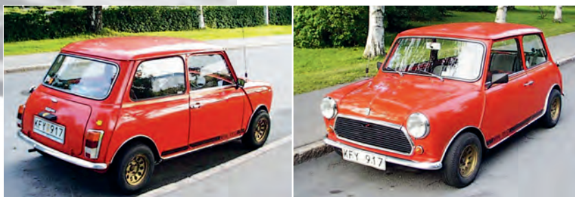
Bild 152. ”Hundkojan” var verkligen ny när den kom 1958. Låg tyngdpunkt och ”ett hjul i varje hörn” gav extremt goda vägegenskaper på slät väg. På ojämna väg var de små hjulen inte lika lyckade. Fjädringen var vätskehydraulisk och att motorn var tvärställd (frambjulsdrift) var också nyskapande. Motorplaceringen bidrog till bilens extrema kompaktitet, trots att innerutrymmet var relativt normalt för sin tid. Bilen har grövre däck än originalet.
