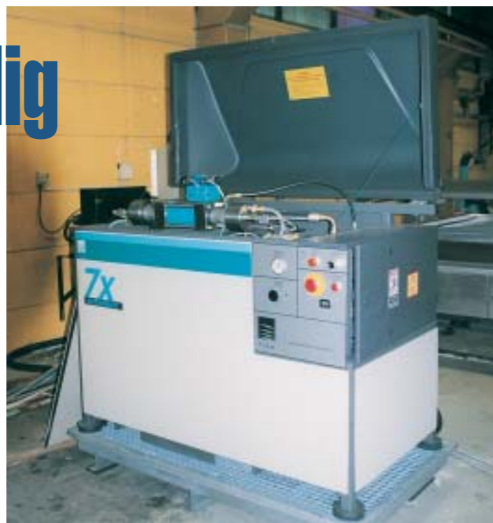
Mälarlasers andra vattenskärningsmaskin som nyligen installerats. Med den fördubblas kapaciteten. Skärprocessen är helautomatiserad. Det som programmeras in på dagen tillverkas på natten.
