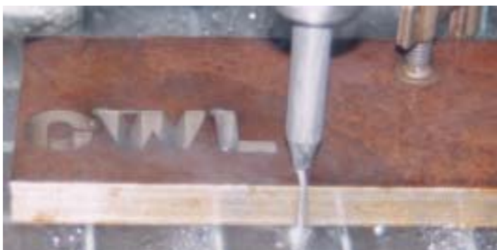
Som synes är det möjligt att åstadkomma det mesta med vattenskärningsteknik, t ex bokstäver mitt i en detalj. Dessutom klarar tekniken de flesta olika material. Även avancerade konstruktionsmaterial, keramik och blandningar av dessa.
