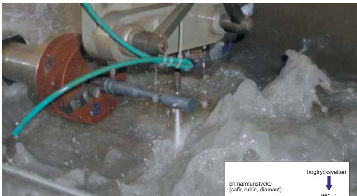
På bilden avverkas det mycket hårda materialet kiselnitrid i en svarvprocess med hjälp av abrasiv vattenskärning.
