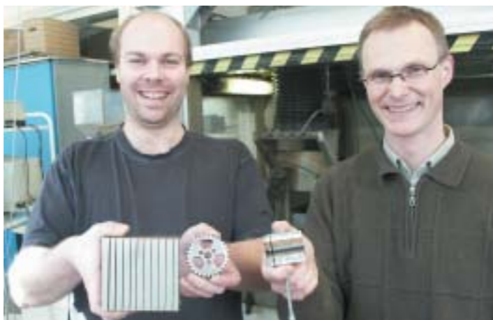
Joakim Hedenfalk, t v och Christian Öjmertz visar olika detaljer som skurits med vattenskriningsteknik. Den bit Christian Öjmertz håller i handen består t ex av hela åtta olika material som skurits vid ett och samma tillfälle, vilket visar vad som är möjligt med den här tekniken.
