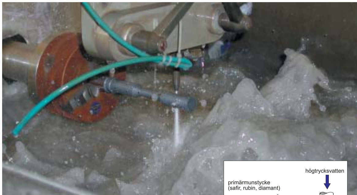
På bilden avverkas det mycket hårda materialet kiselnitrid i en svarvprocess med hjälp av abrasiv vattenskrining.
