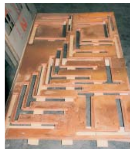
Ett exempel där vatten använts för att skära i koppar. Laserteknik går inte att använda på koppar eftersom strålarna reflekteras tillbaka. Vattenskärning är det enda som fungerar.
