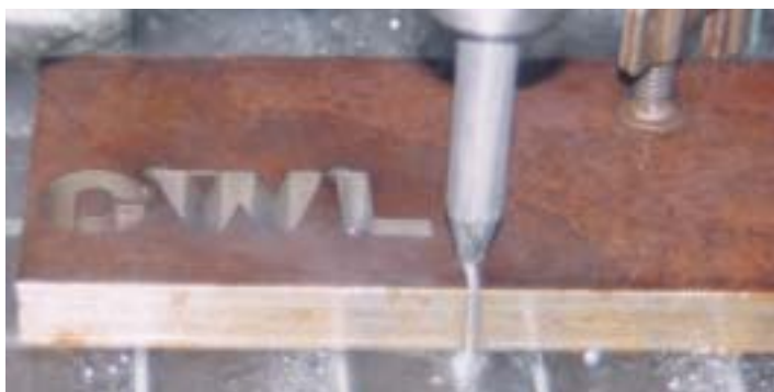
Som synes är det möjligt att åstadkomma det mesta med vattenskriningsteknik, t ex bokstäver mitt i en detalj. Dessutom klarar tekniken de flesta olika material. Även avancerade konstruktionsmaterial, keramik och blandningar av dessa.
